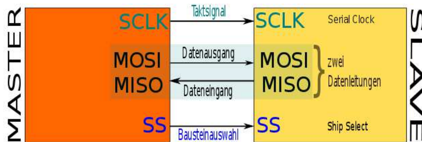
Abbildung 1.1. Vier Leitungen werden für die Kommunikation benötigt. Hiervon sind zwei Leitungen für den eigentlichen Datenaustausch notwendig. Eine Leitung (SCLK) gibt ein Taktsignal vor und eine andere (SS) ist für die Bausteinauswahl zuständig.
